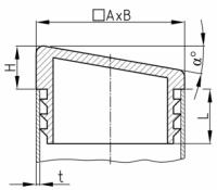
• \*) = Der Gleiter VS20 kann auch ab einer Wandstärke von 1 mm eingesetzt werden. Wir empfehlen, dies vor Einbau zu prüfen.
