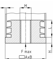
• \* ) = Die Stopfen können auch bis zu einer Wandstärke von 2 mm eingesetzt werden. Wir empfehlen, dies vor dem Einbau zu überprüfen.
